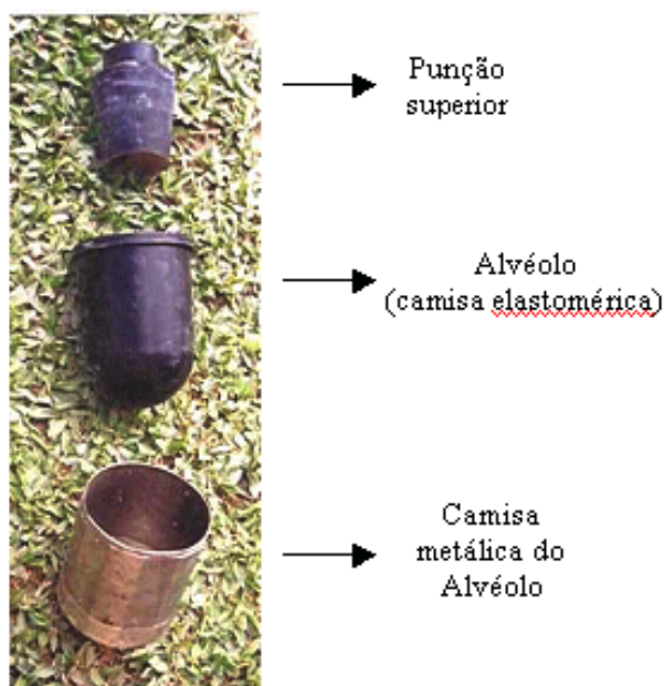
Fig. 2. Constituição de um molde isostático.
