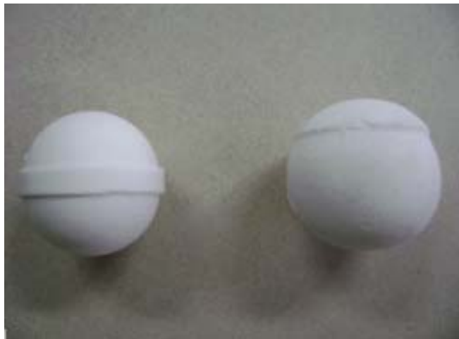
Fig. 13. Corpos moedores conformados: (esquerda) conformação hidráulica; (direita) conformação isostática.
